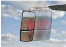
**ELECTRONIC TELESCOPING MIRRORS ARE CONTROLLED FROM INSIDE THE CAB FOR GREATER COMFORT. THE OPERATOR ALWAYS HAS THE BEST OVERVIEW OF HIS OR HER SURROUNDINGS, EVEN WHEN USING LARGE IMPLEMENTS IN CONFINED SPACES.**
